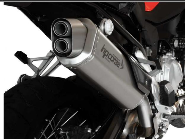
Terminale omologato \* **4-TRACK**: corpo in **acciaio ceramizzato nero** con fondelli in acciaio satinato + paracalore in carbonio + raccordo per collettori originali con paracalore in acciaio satinato.
