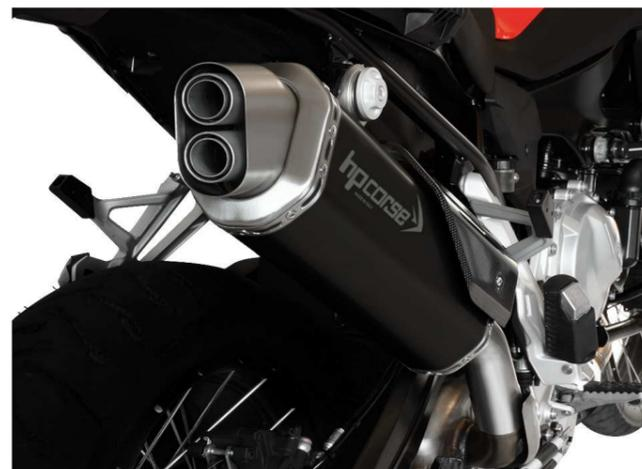
Terminale omologato \* **4-TRACK**: corpo e fondelli in **acciaio satinato** con fondelli in acciaio satinato + paracalore in carbonio + raccordo per collettori originali con paracalore in acciaio satinato.
