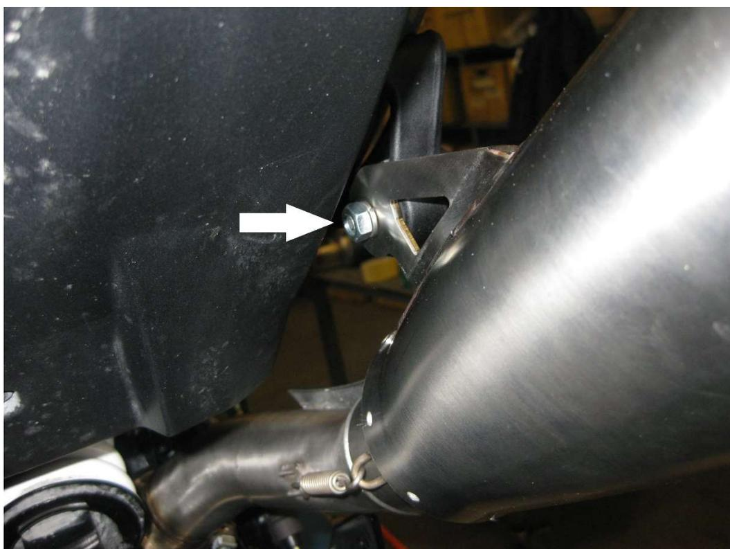
FASE 5: Serrare la fascetta e successivamente serrare le viti di fissaggio al telaio
