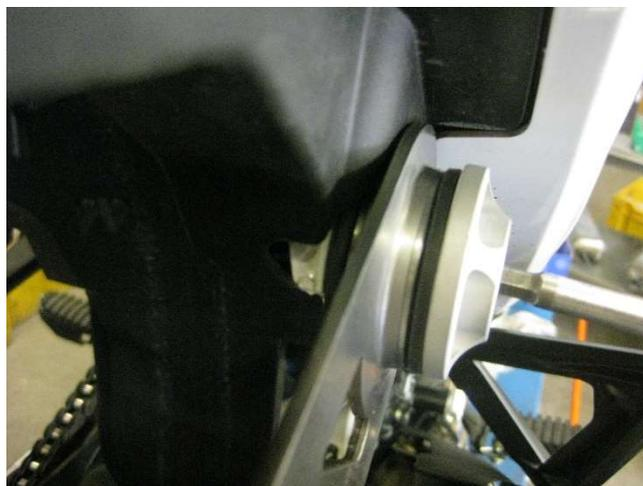
FASE 8: Serrare la fascetta e successivamente serrare la vite di fissaggio al telaio
