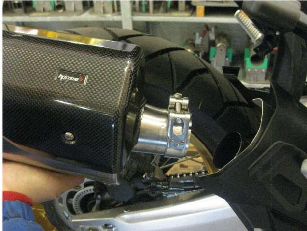
FASE 7: Puntare la vite di fissaggio insieme alla sua boccola, facendo attenzione a mettere in battuta con il telaio la rondella in dotazione come da foto
