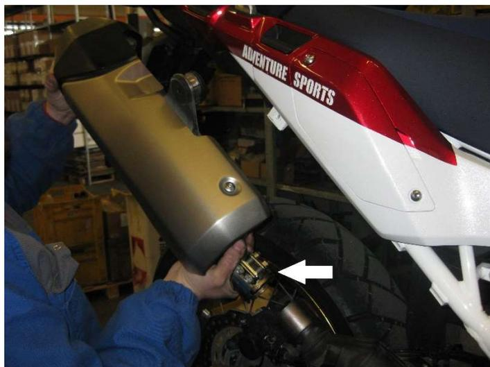
FASE 6: Montare la fascetta sul raccordo, inserire il silenziatore HP CORSE 4-TRACK
