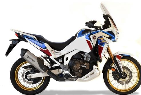
SPS CARBON è dotato di un bellissimo finale in fibra di carbonio che va a rivestire il beccuccio idroformato in acciaio. Omologato Euro 5, ha la cover para calore in fibra di carbonio, il raccordo slip-on, il logo inciso al laser ed è disponibile in tre diversi materiali: titanio, acciaio satinato, acciaio ceramizzato nero. Scarico con doppia uscita dei gas di scarico, involucro ottagonale, beccuccio interno ovoidale con doppio Db-Killer estraibile.
