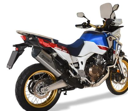
SPS CARBON è dotato di un bellissimo finale in fibra di carbonio che va a rivestirne il beccuccio idroformato in acciaio. Omologato Euro 4, ha la cover para calore in fibra di carbonio, il raccordo slip-on, il logo inciso al laser ed è disponibile in tre diversi materiali: titanio, acciaio satinato, acciaio ceramizzato nero. Scarico con doppia uscita dei gas di scarico, involucro ottagonale, beccuccio interno ovoidale con doppio DB-Killer estraibile.
