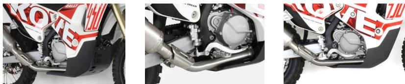
Il motore può essere ulteriormente potenziato con il RACCORDO CENTRALE non catalitico e la MAPPATURA DEDICATA sviluppata al banco prova, per un'erogazione di potenza massima di + 6.8 CV a 9985 rpm e + 4 Nm di coppia a 7000 rpm.
