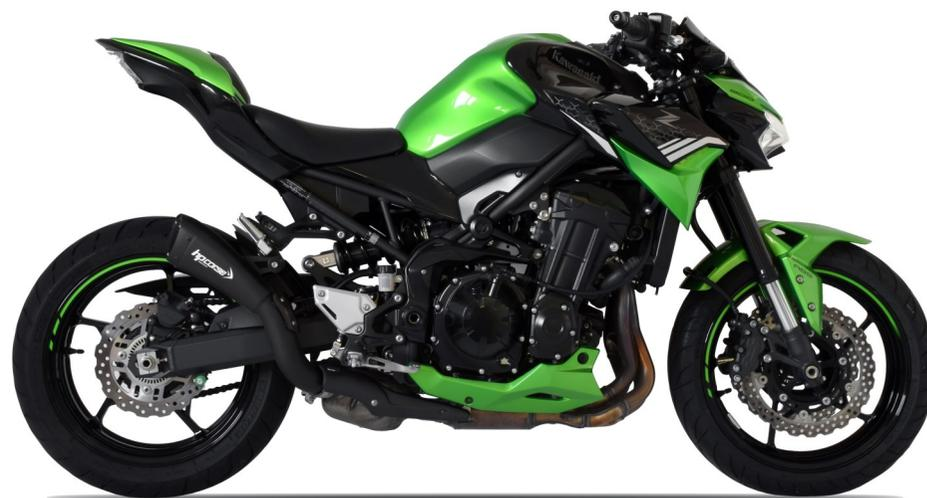
HP CORSE HYDROFORM SHOT R Linea compatta, silenziatore in acciaio inox plasmato tramite idroformatura per un peso di poco superiore al chilogrammo e un sound unico. Omologato Euro 4/5 e Racing con DB-Killer estraibile (Scarico Racing) è proposto sia nella versione satinata, che in quella ceramizzata nera.
