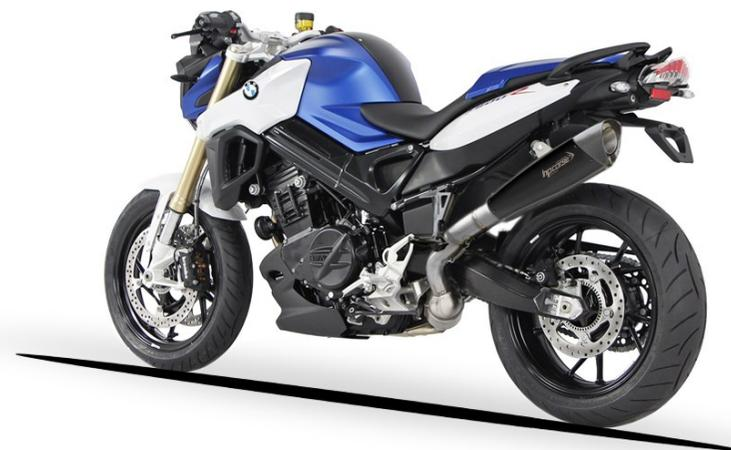
Per la "Naked" di casa BMW, proponiamo l'ultima linea di scarichi prodotta da HP CORSE: EVOXTREME LINE. Involucro a sezione variabile ottenuto mediante una raffinatissima tecnologia di deformazione dei metalli Made in HP CORSE, fondello pentagonale "slash" in leggerissima fibra di carbonio, raccordo slip-on con sgancio rapido a molla. Omologato E3 con DB-Killer estraibile, EVOXTREME è disponibile satinato o satinato nero.
