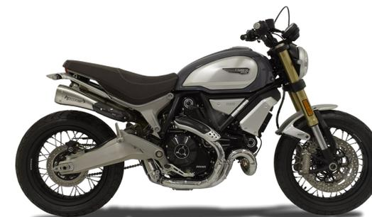
Stesse caratteristiche dello scarico precedentemente presentato ma con finale di uscita differente. La versione "CORSA" dell'HYDROFORM SHORT qui proposta presenta un finale co rete metallica non asportabile senza DB-Killer.
