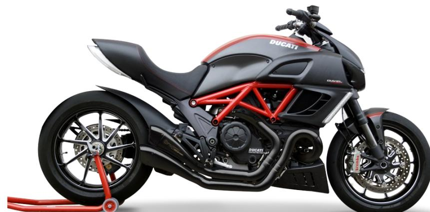
**HYDROFORM FACTORY NON** è un sistema di scarico con doppio silenziatore e raccordo 2 in 2 indipendenti e mantiene i due collettori primari originali eliminando il raccordo secondario 2 in 1 con la valvola farfallata. E' una configurazione non omologata Racing con DB-Killer estraibili (gli stessi forniti per la versione omologata EVOLUTION) e DB-Killer Performance maggiorati in dotazione nel kit. Disponibile in acciaio inox satinato e acciaio ceramizzato nero.
