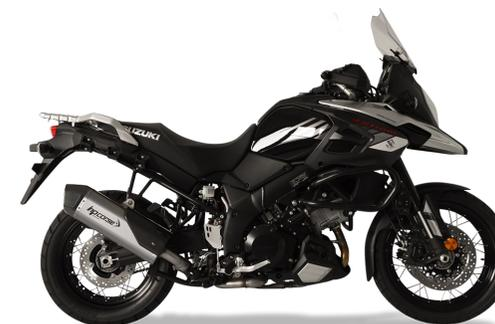
SPS CARBON differisce dal modello 4-TRACK R solo esteticamente in quanto adotta un fondello di uscita in fibra di carbonio che va ad avvolgere il beccuccio in acciaio inox idroformato. Tutte le altre caratteristiche rimangono le medesime.
