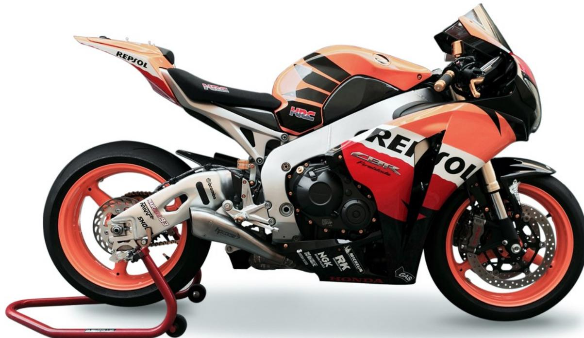
Per HONDA CB 1000 RR HYDROFORM LINE con sistema di attacco slip-on e raccordo a "S" a passaggio basso. Il terminale ha il corpo in acciaio inox satinato e un raccordo a settori saldato manualmente mediante tecnologia TIG. Omologato E3 per le emissioni acustiche, HYDROFORM è provvisto di DB-Killer omologato estraibile e viene fornito con un secondo db-killer Performance per esaltare al meglio le prestazioni e le doti sportive della Maxi di casa HONDA.
