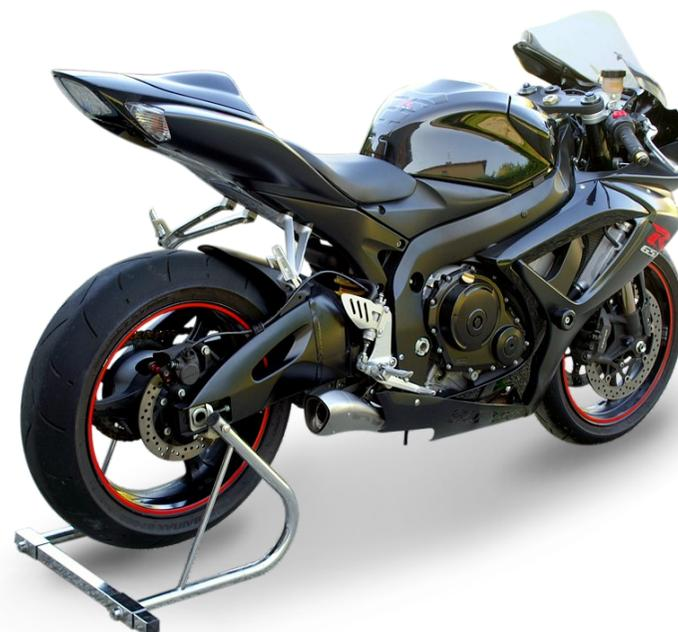
Uno scarico unico che sembra nato proprio per questa moto. Montaggio estremo in posizione "low", esce dalla carena come un' appendice della stessa per un effetto unico. HYDROFORM LINE è omologato E3 con DB-killer estraibile ed ha un raccordo slip-on per il montaggio sui collettori originali. Disponibile in due finiture superficiali, satinato e ceramizzato nero. Scarico con omologazione E3 per motori 78/88,3/92/108,8/110,3 Kw.
